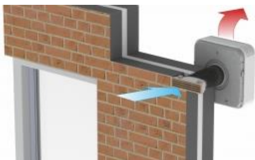
Figuur 5.9 Decentrale balansventilatie
