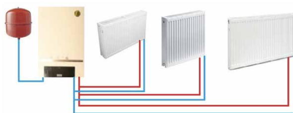
Schematische weergave van centrale verwarming
